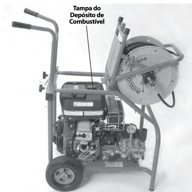
Figura 8 - Acesso ao Depósito de Combustível KJ-3100
