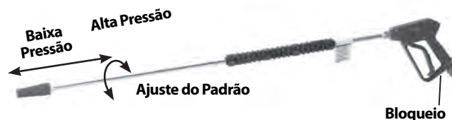
Figura 17 – Ajustes do Bocal da Varinha
