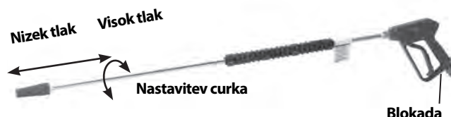
Slika 17 – Nastavitev šobe na čistilnem drogu
