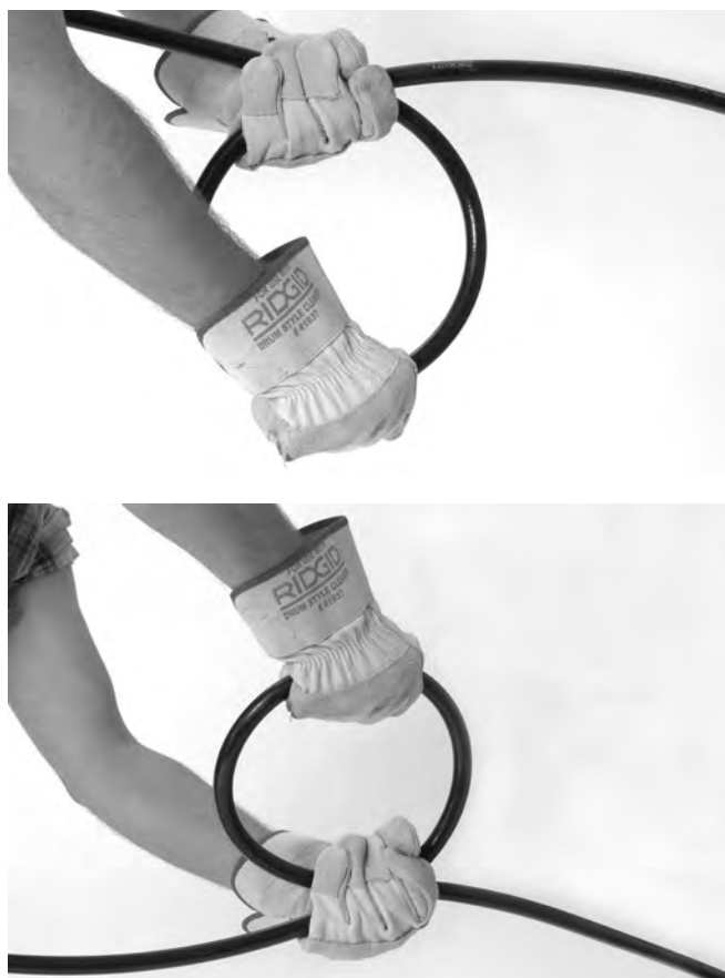
Slika 15 – Rotiranje gibljive cijevi
