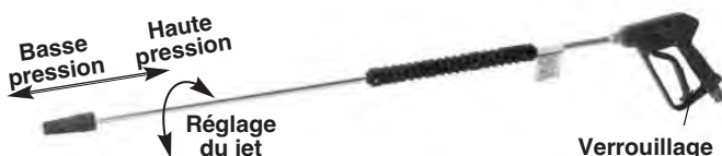
Figure 17 – Réglages du pistolet de lavage
