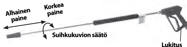
Kuva 17 – Pesuvarren suuttimen säädöt
