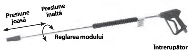
Figura 17 – Reglările ajutorului pistolului de spălare
