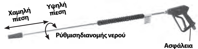
Εικόνα 17– Ρυθμίσεις κεφαλής για το πιστόλι πλυστικού
