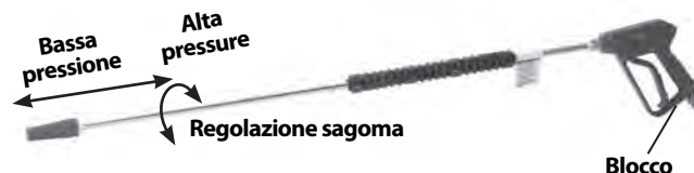
Figura 17 – Regolazioni iniettore lancia di lavaggio
