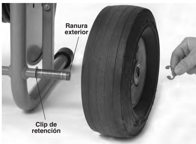
Figura 4 – Ensamblaje del carro de la KJ-2200
