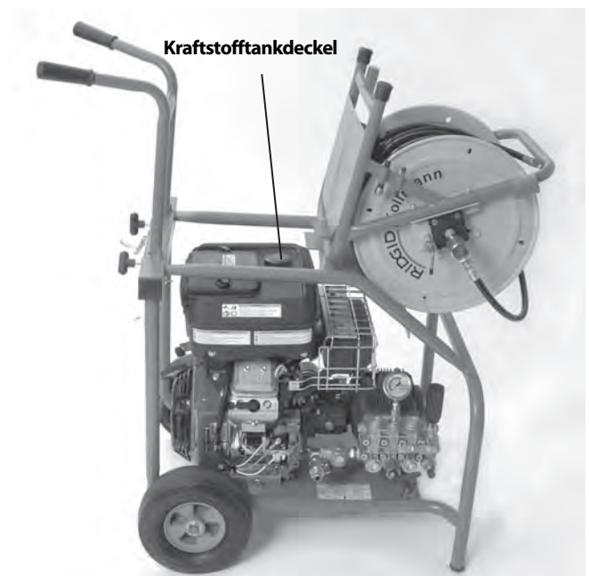
Abbildung 8 – KJ-3100 Zugang zum Kraftstofftank
